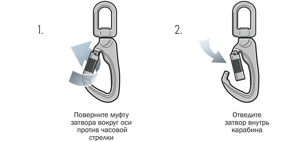
Рис. 3 Принцип работы карабина класса Т.
