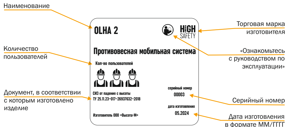
Рис. 3 Маркировка противовесной мобильной системы OLHA 2.
